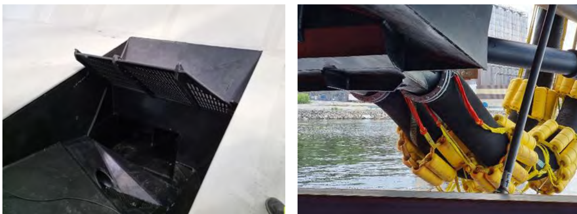
Figur 19 Venstre: Fisketappekum i bunn av merd. Høyre: 2 stk. losseslanger tilkoblet fisketappekum
