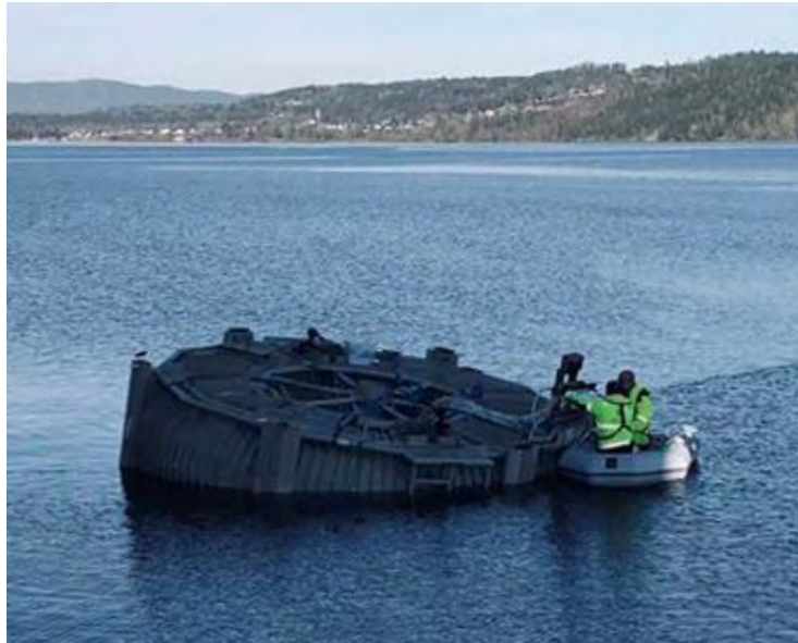
Figur 98: Krengeprøve ifm. utvidet testing hos Bluegreen Fusion
