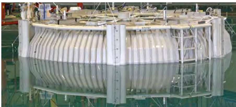
Figur 8: Marine Donut (1/10-modell) i halvt hevet/dellast kondisjon hos Sintef [12]
